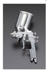
使用圧力...0.3 ~ 0.35MPa 吐出し空気量...100L/min ノズル径...1.3mm 取付ねじ...1/4"PF カップ容量...400ml 所要コンプレッサー...0.4kw 重量...660g 一般塗装用、水系塗料にも対応 ガン重量・・・420g ノズル、ニードル弁材質・・・ステンレス製 ボディ材質・・・クロームメッキ仕上げ
