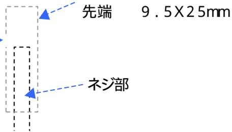
ドラムブレーキのリターンスプリングの脱着に使用する工具。
