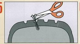
表面のクッションゴムが溶けて傷穴を完璧に塞ぎます。3~10 分待ってエアーもれの有無をチェックして下さい。修理部分 からのもれがない場合はタイヤの表面に出ている部分を切って下さい。
