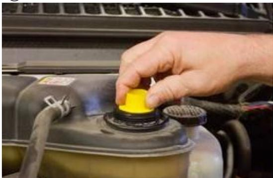
①ラジエーター注入口のキャップを外して、パッキン付アダプターを取り付けます。(アダプターの径及び高さをご確認下さい。)
