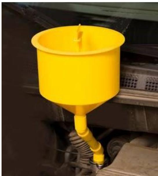
②取り付けアダプターの上に、アダプターに合うキャップ、エルボ、バー、エルボ、本体の順で確認の上接続して下さい。
