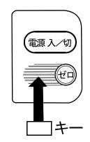
□ この機能が"働く/働かない"は内部に記憶されています。 どの状態にあるかは、通常の計量値表示において、ゼロ キー と □ キーを同時に押したときの表示で確認できます (キーを押している間、下記が表示されます)。
