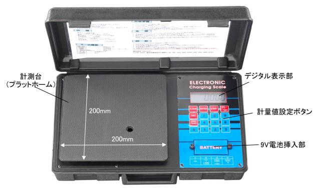
※ 当製品は9Vアルカリ電池にてデジタル表示を行なっております。 電池が消耗すると誤表示や、正しい計測が出来なくなることがあります。 ご使用の際は、電池の電圧チェックと予備電池の携帯をお勧めします。
